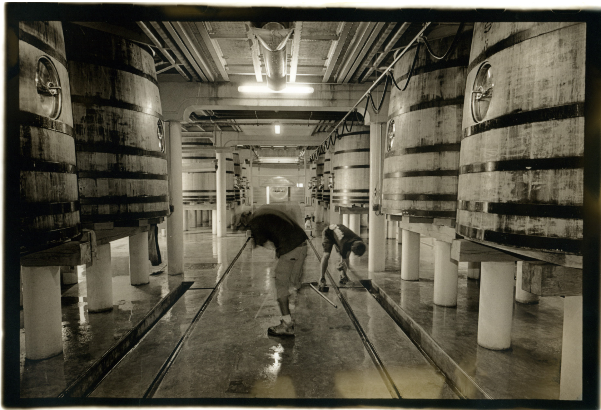
Nos chais de vinification en vallée du Rhône sont tous les trois construits en utilisant le principe de la gravité, pour recevoir la vendange ; principe qui permet un respect optimum des raisins jusqu'à leur arrivée en cuve
